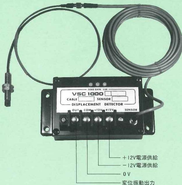
回転機械や高速で動く機構部の開発・試験・点検での変位振動の測定、分析など非接触測定の広範な用途にご使用いただけます。測定用途の他に、産業用回転機械、FA、自動車、鉄道、土木建築、材料試験、コンピュータ周辺機器などの分野における監視・制御・試験器機のセンサユニットとしてのご利用もできます。磁性体金属、非磁性体金属(SUS304、アルミ等)の出力特性が変換器の能動範囲に入るように最適に設計されておりますので再調整が不要な使い易いローコストな非接触変位計です。出力はFFT、波形記録計、オシロスコープ、デジタル電圧計で観測できます。
