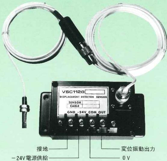
タービン発電機、ポンプ、送風機、圧縮機などの回転機械の軸振動、軸位置、回転数を常時モニタして、回転機械の異常検知、予防保全のデータ取得をするモニタ装置(600シリーズ)専用設計された信頼度の高い非接触変位計です。モニタよりの-24V電源で動作します。
