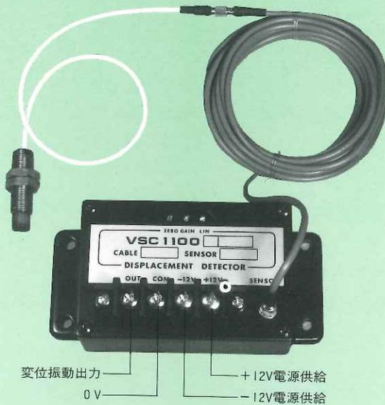
回転機械や高速で動く機構部の開発、検査、点検での変位振動の測定、分析など非接触測定の広範な用途にご使用いただけます。特殊用途向けセンサとの組み合わせや標準校正材質 (SCM4) 以外でも標準感度に校正できる変位計です。出力はFFT、波形記録計、オシロスコープ、デジタル電圧計で観測できます。
